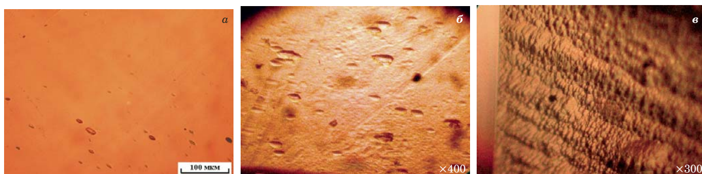
Рис. 4. Микроструктура монокристаллов ЛРТ в исходном состоянии (а), после термоудара ( \Delta T = 100\text{ }^\circ\text{C} ) (б) и приложения циклических нагрузок (в)
