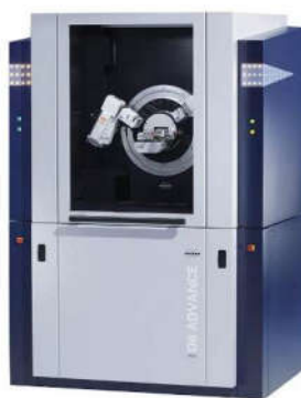
Рисунок 2.19 – Внешний вид дифрактометра D8 Advance
