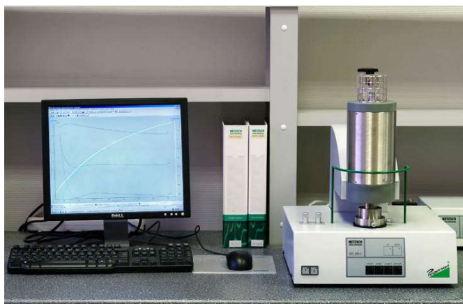
Рисунок 2.25 – Внешний вид дифференциального сканирующего калориметра DSC 404 C Pegasus
