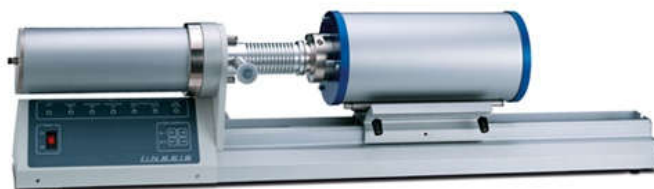
Рисунок 2.26 – Внешний вид дилатометра LINSEIS 76/1000
